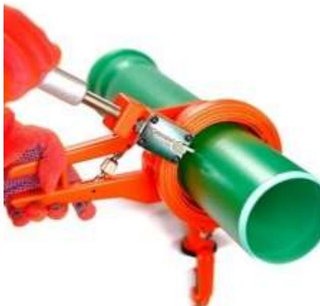
Труборез-фаскосниматель Ostendorf Werkzeug 50-110 мм
